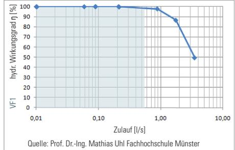
Durchschnittliche Regenspende in Deutschland zu 80% unter 15 l/(sxha), das ergibt einen Volumenstrom von 0,58 l/s bei einer Dachfläche von 387 m<sup>2</sup>.
