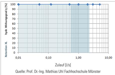
DN 125: Durchschnittliche Regenspende in Deutschland zu 80% unter 15 l/(sxha), das ergibt einen Volumenstrom von 0,58 l/s bei einer Dachfläche von 387 m<sup>2</sup>.
