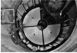
2. Mit den beiden Filtern unter dem Ablauf beginnen, dann die anderen befestigen
