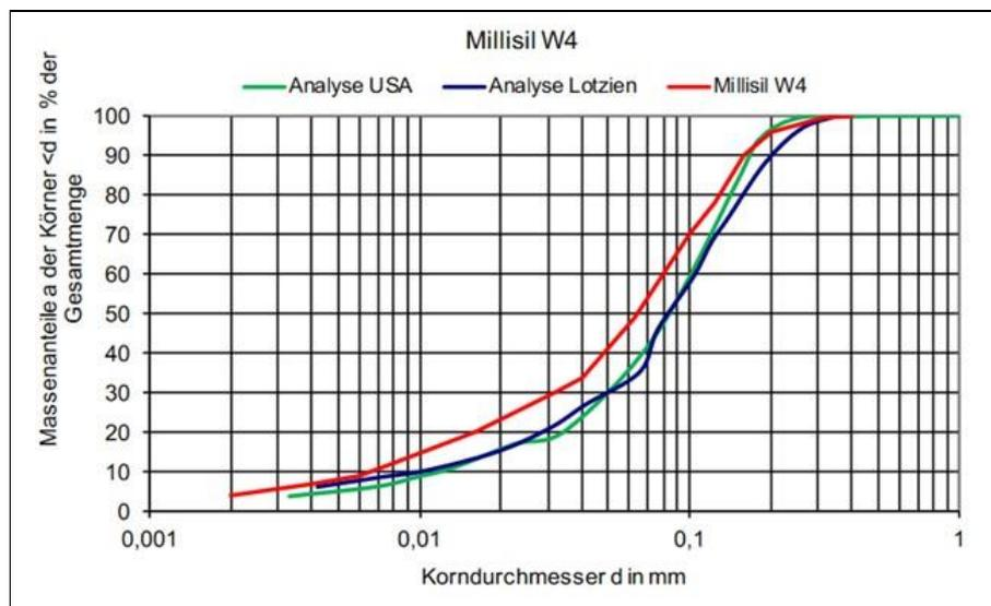
Bild 2-3: Korngrößenverteilung des verwendeten Millisils im Vergleich zur Soll-Korngrößenverteilung Millisil W4 gemäß den Angaben der Herstellerfirma Quarzwerkegruppe
