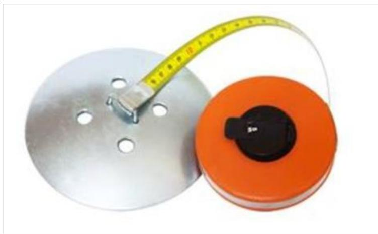
Bild 3-5: Schlammteller zur Messung der Schlammhöhe [Börder GmbH, 56743 Mendig]
