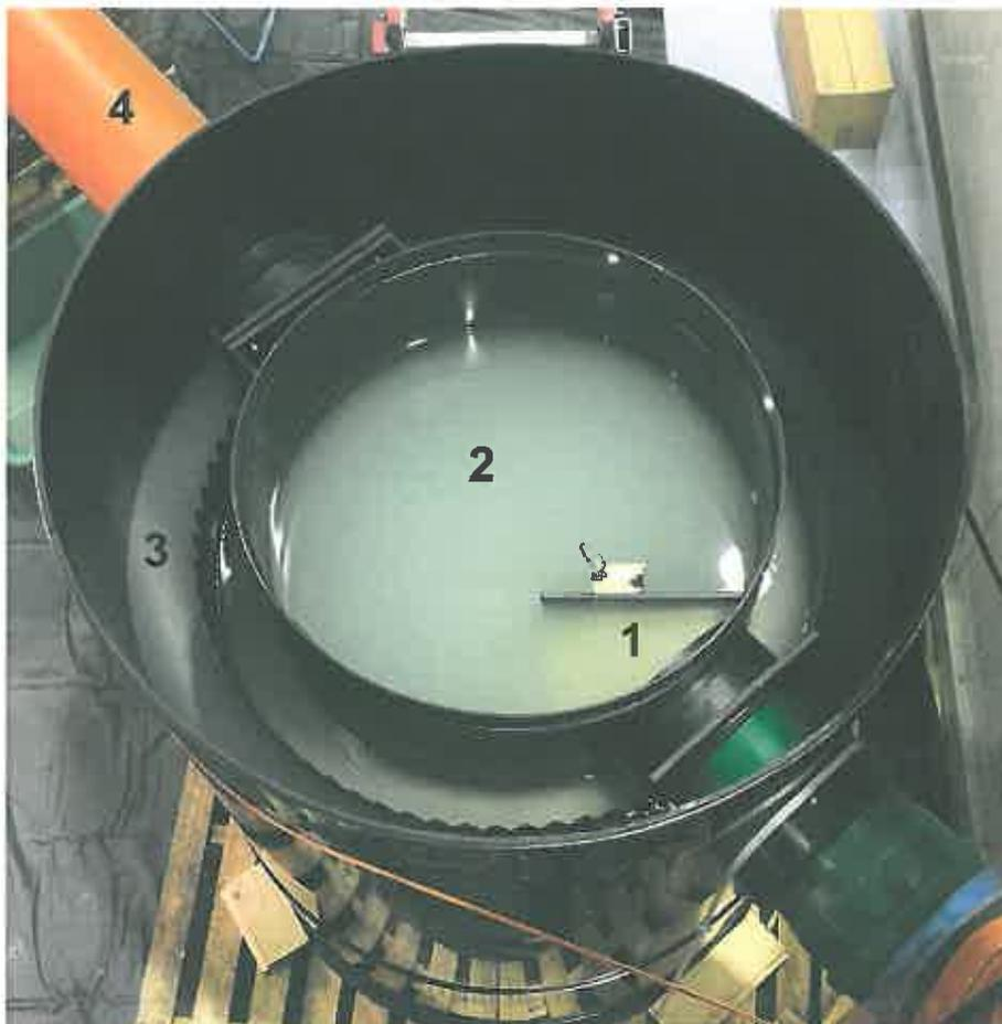
Abb. 2: Blick in den Hydroshark mit den einzelnen Komponenten: Zulauf (1), Absetzbereich (2), Zackenwehr (3) sowie Auslauf (4).
