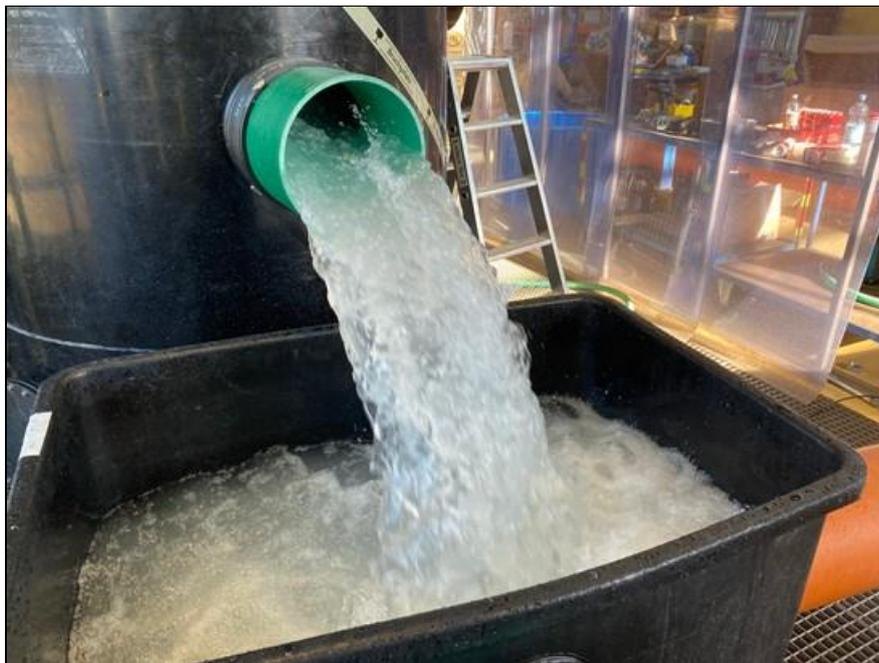
Bild 2-1: Spültest des Hydrosharks DN 1500 im Teststand der Firma Axel Zangenberg am 25. November 2020
