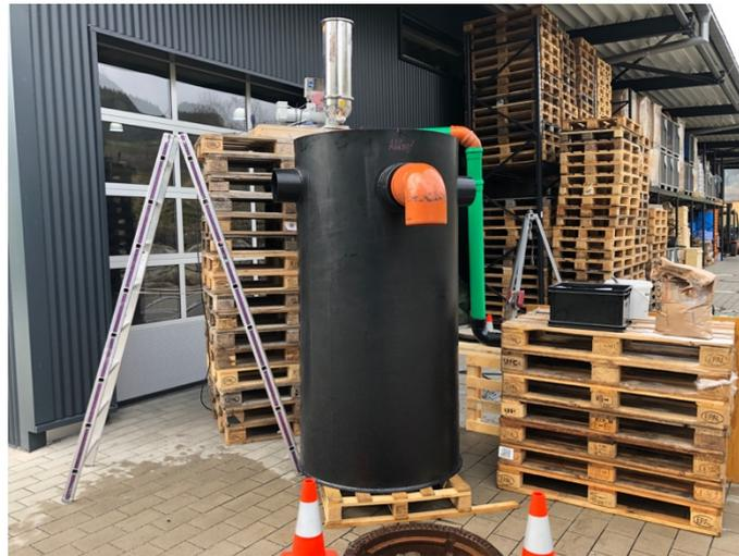
Abbildung 8: Aufbau der Prüfanlage für den Typ Hydroshark HS 1,0
