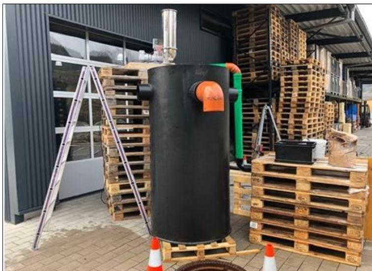
Bild 2-2: Aufbau des Hydrosharks DN 1000 für die Feststoffprüfung [Dierkes, 2019]
