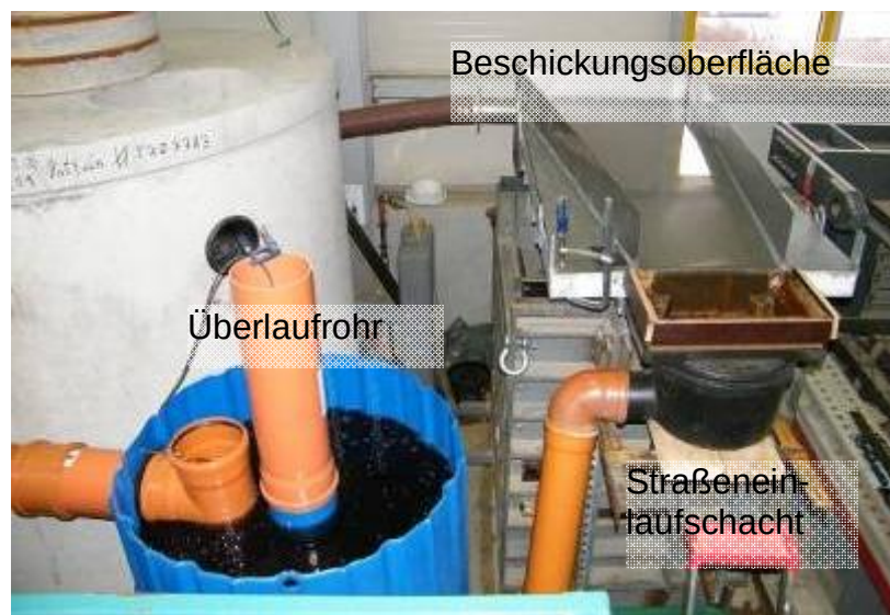
Abbildung 29: Versuchsaufbau 3P Hydrosystem 1000 heavy traffic.
