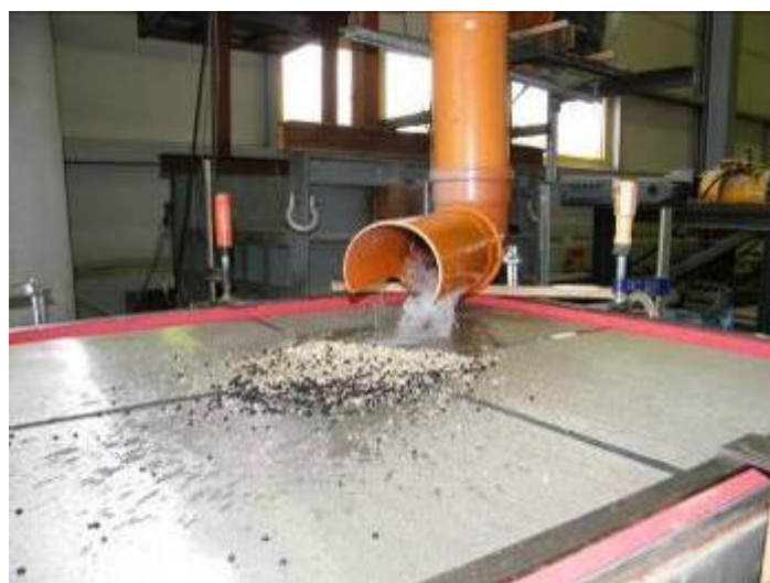
Abbildung 39: Ausgetragene Menge an Material als Rückstand auf dem Siebturm.
