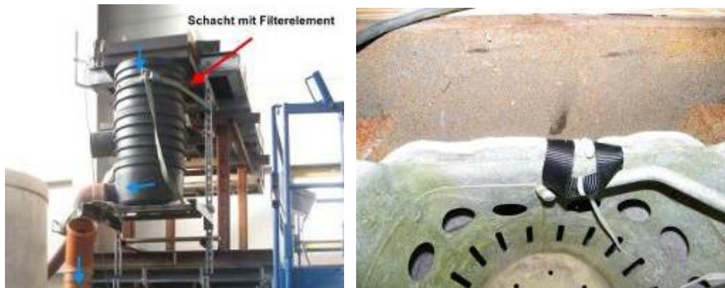
Abbildung 18: Links: Versuchsaufbau mit Filterelement im Schachtkörper, Ansicht. Rechts: Anbindung des Filterelements an den Schmutzfang mit Rasterbändern.
