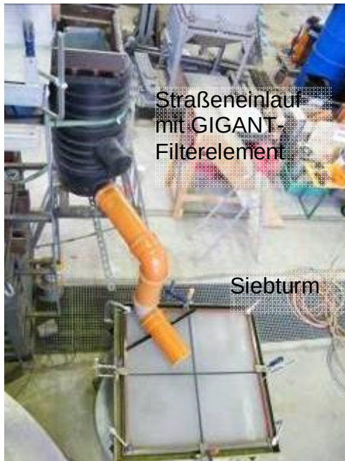
Abbildung 33: Links: Versuchsaufbau Geotextil-Filtersack zur stofflichen Untersuchung (Kies-Sand/Schwebstoffe). Rechts: Rückstand im Grobschmutzfang vor dem Geotextil-Filtersack (Kies-Sand-Gemisch).
