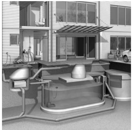
Einbau Volumenfilter in Vorschacht
